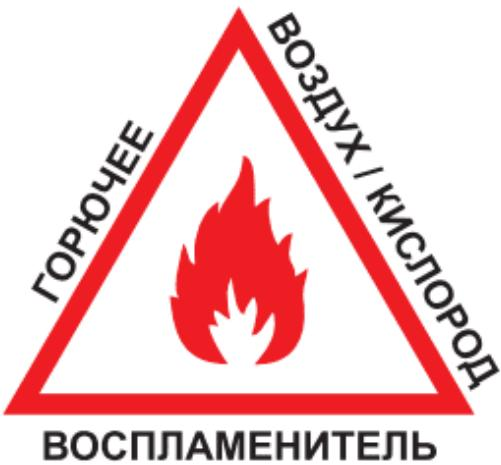
Если концентрация пыли, газа или пара в воздухе находится между верхним и нижним пределами воспламенения и воспламенитель имеет достаточную энергию или температуру, может произойти пожар или взрыв.
