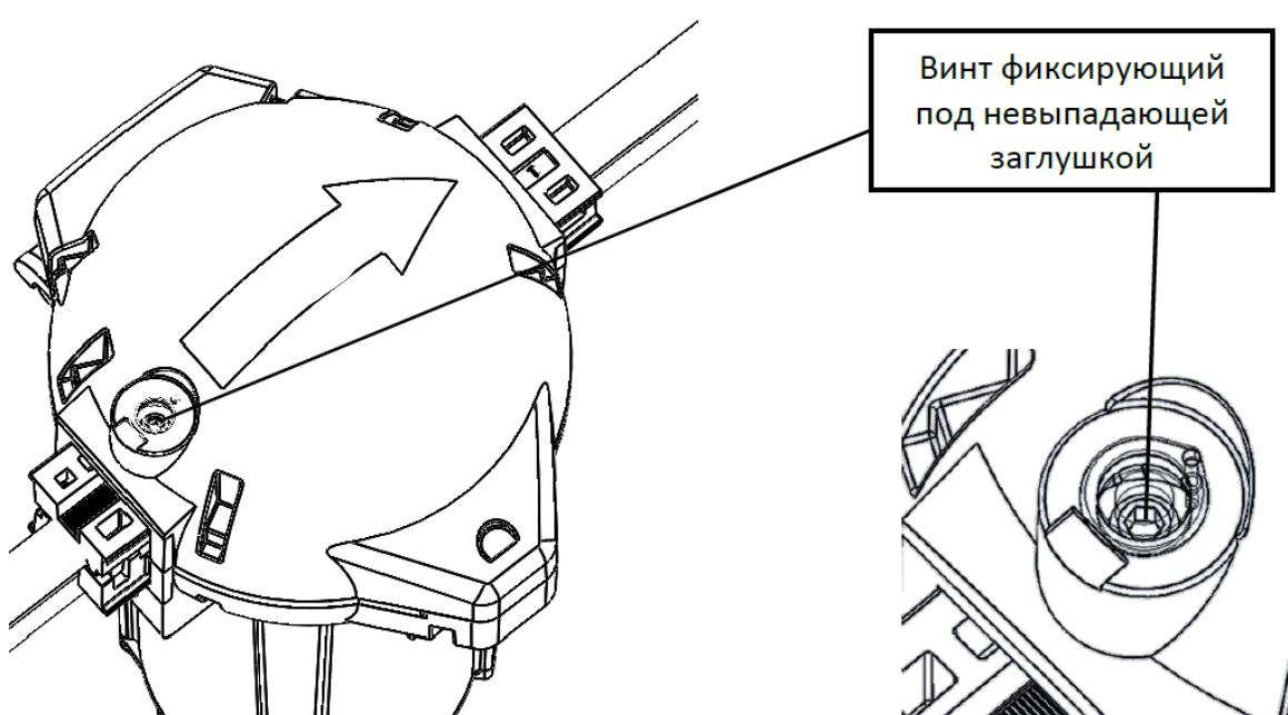
Рисунок Г.3 Фиксирующий клинья винт,
