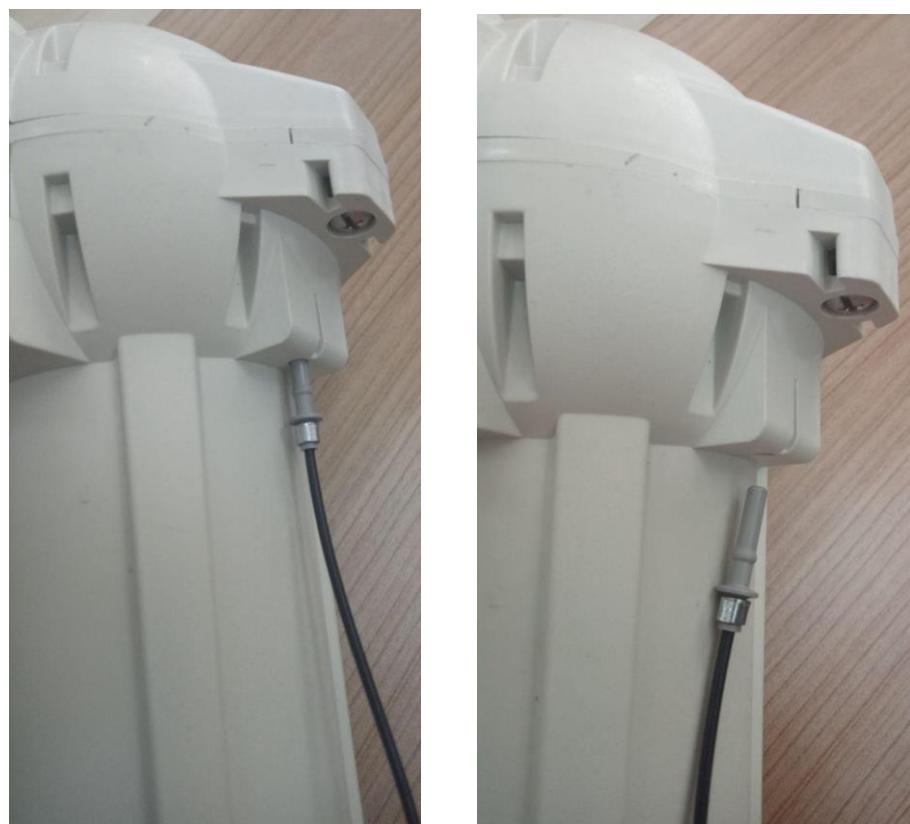
Рисунок 9 – Подключение внешнего дистанционного оптического кабеля
