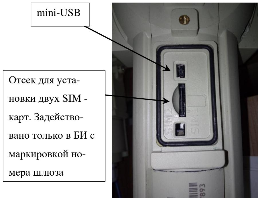
Рисунок 8 - Отсек для установки SIM карт
