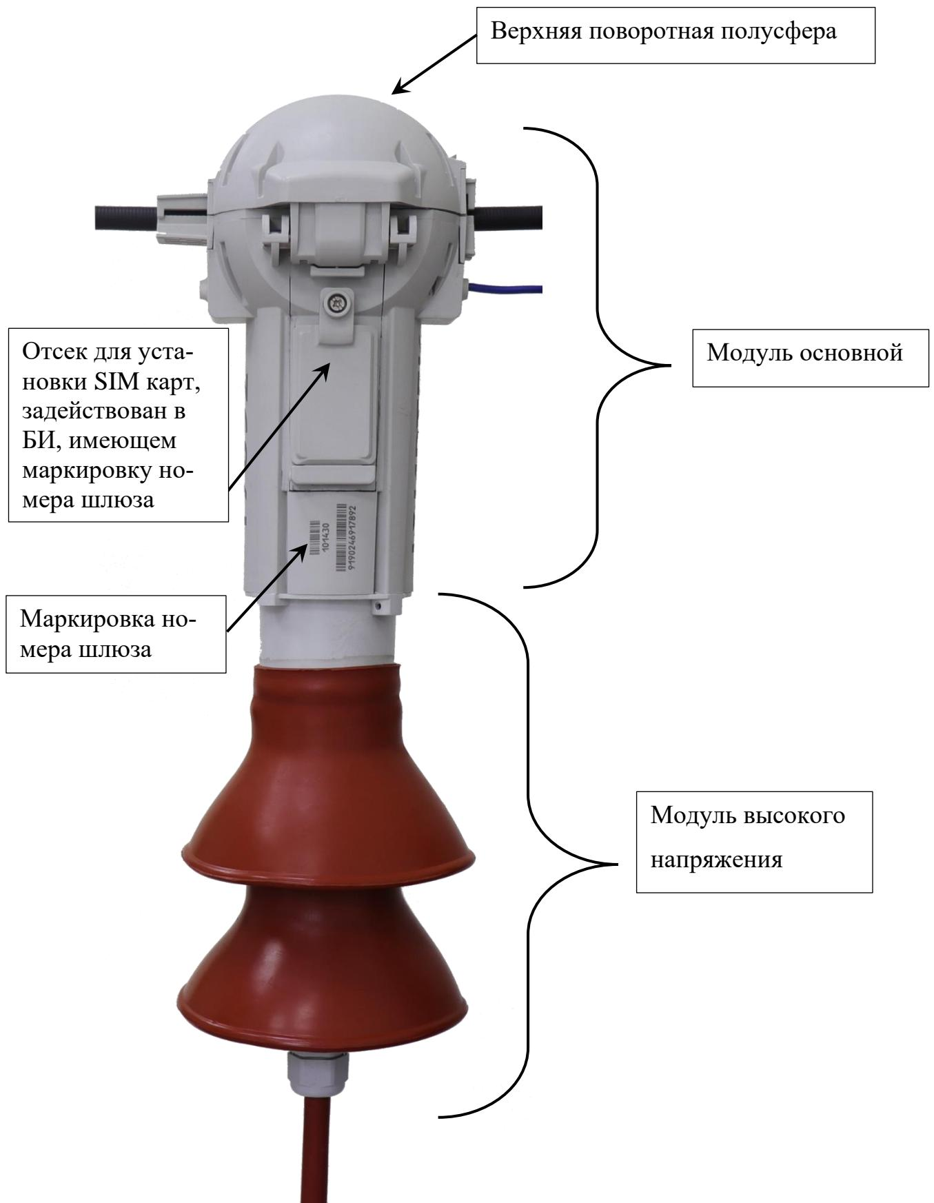
Рисунок 7 – Состав блока измерительного
