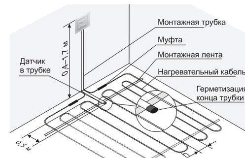
Рисунок 1. Монтаж терморегулятора и системы «теплый пол»
