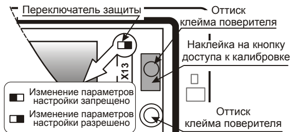
Рис. 3.1а – Места пломбирования поверителем
