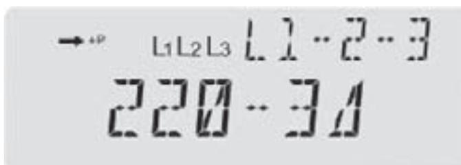
Рисунок 9.5 – Трехпроводная сеть с номинальным напряжением 220 В
