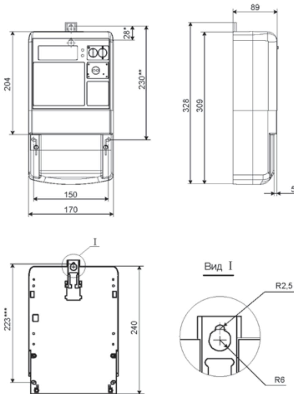
\* размер для верхнего положения кронштейна с крепежным ушком относительно нижнего положения кронштейна
