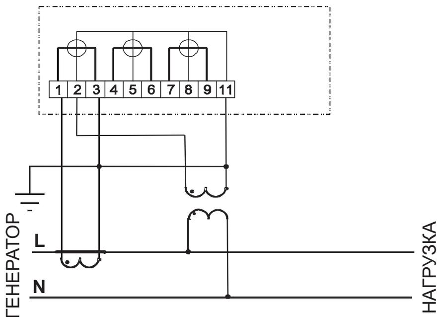
Рисунок 12.14 – Схема включения трехэлементного счетчика в однофазную сеть
