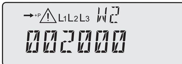
Рисунок 10.3 – Отображение кода предупреждения “W2 002000”
