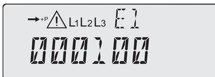
Рисунок 10.2 – Отображение на ЖКИ кода ошибки “E1 000100”
