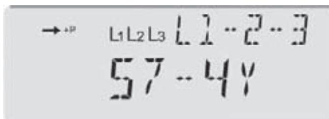
Рисунок 9.2 – Четырехпроводная сеть с номинальным напряжением 57,7 В
