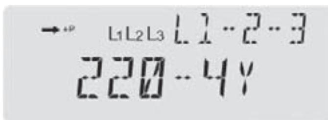
Рисунок 9.3 – Четырехпроводная сеть с номинальным напряжением 220 В
