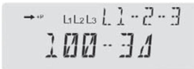
Рисунок 9.4 – Трехпроводная сеть с номинальным напряжением 100 В
