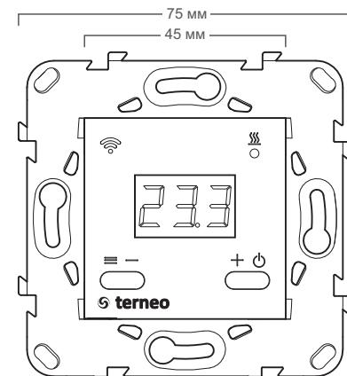
Рисунок 1. Габаритные размеры
