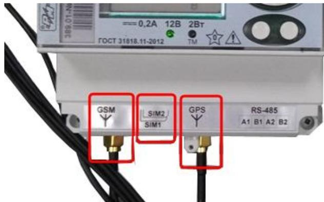
8. Подключить антенну GSM/GPS через удлинители в соответствующие разъемы и вынести наружу
